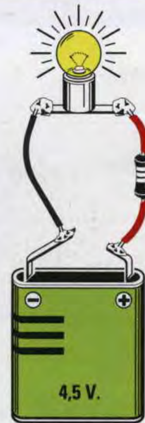
Fig.61 Applicando una resistenza da 10 ohm 1 watt in serie ad una lampadina vedremo scendere la sua luminosità, perché la resistenza ha ridotto il flusso degli elettroni.
