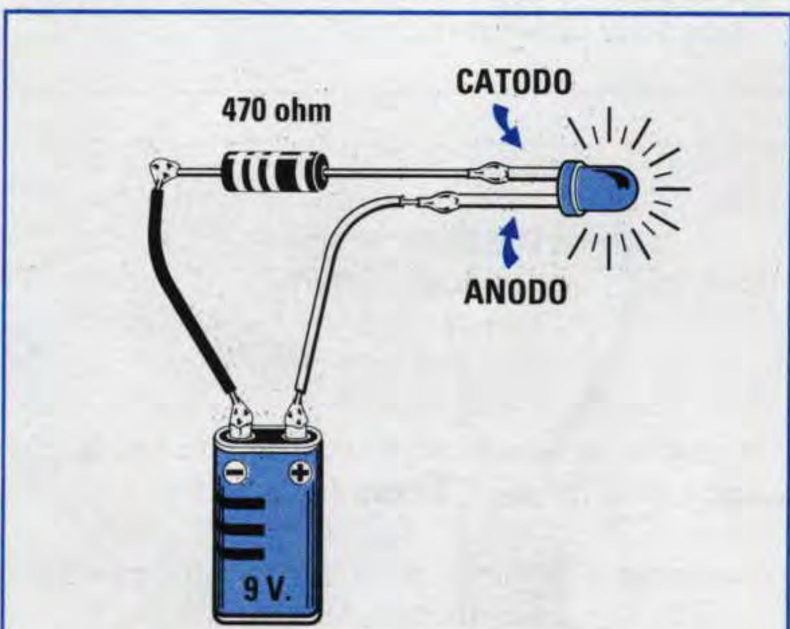
Fig.96 Se non colleghiamo in serie su uno dei due terminali una resistenza di valore appropriato il Led si brucerà. Per calcolare il valore di questa resistenza utilizzate la formula riportata in alto sul biglietto.
