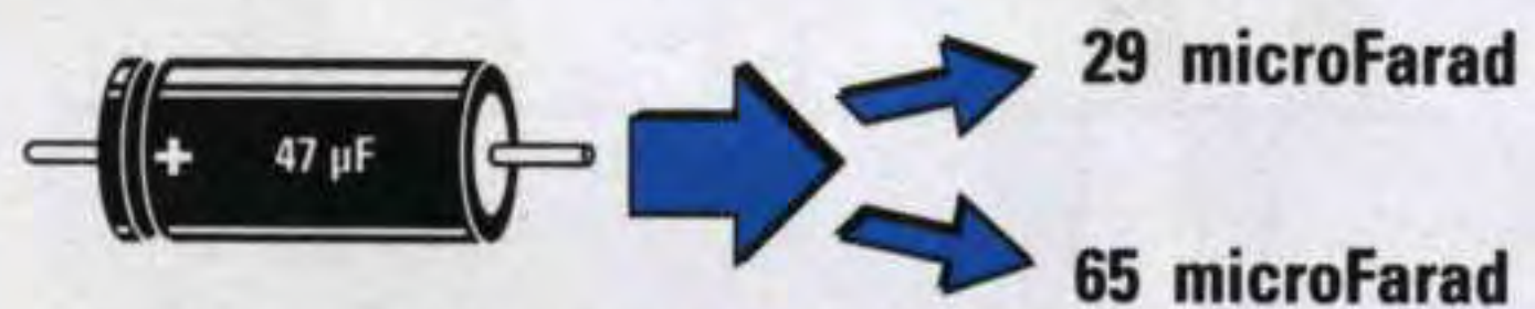
Fig.87 I condensatori elettrolitici hanno delle tolleranze comprese tra il 40 - 50% quindi una capacità dichiarata di 47 mF può risultare in pratica di 29 o di 65 mF.
