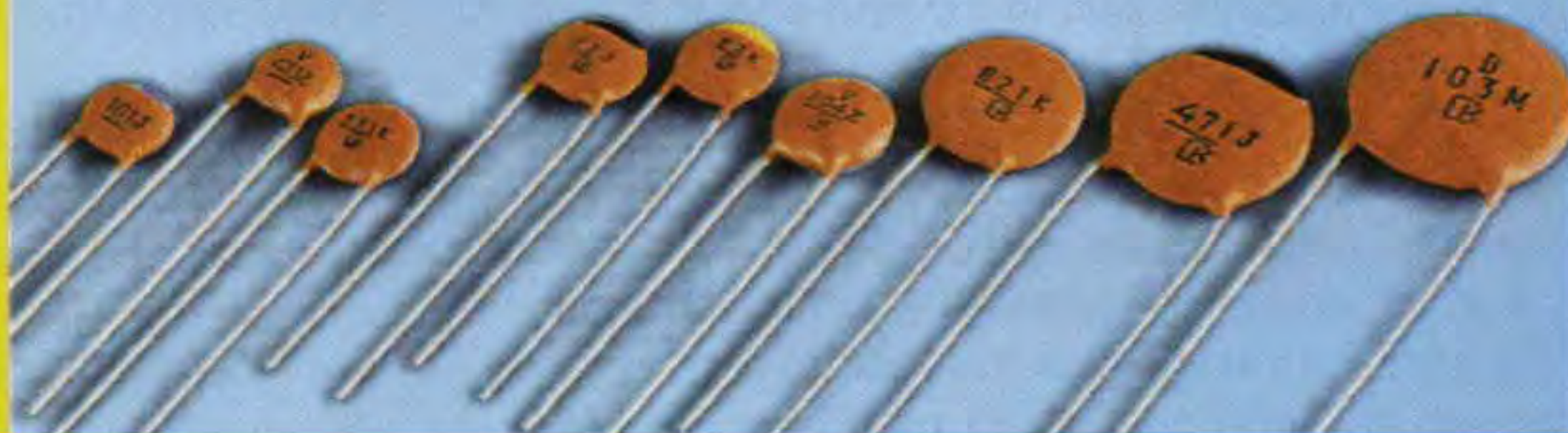
Fig.69 I condensatori Ceramici sono chiamati così perché l'isolante che separa le due piastre A/B è di ceramica.
