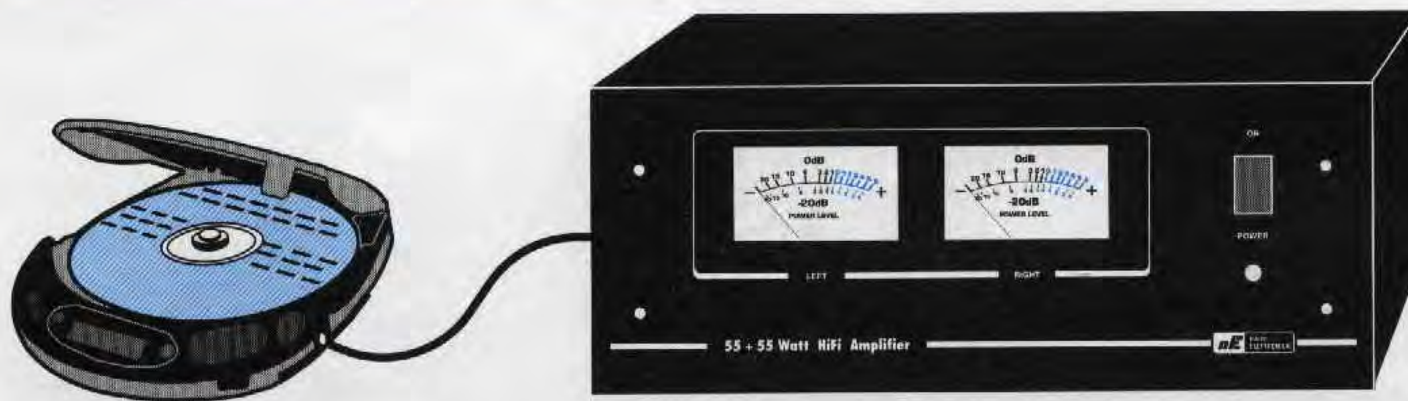
Fig.27 Se collegate l'uscita di un Compact Disc sull'ingresso dell'amplificatore dovette inserire gli spinotti di cortocircuito sui terminali B - A dei connettori J1 - J2. In questa posizione otterrete il massimo Guadagno (30 dB circa).
