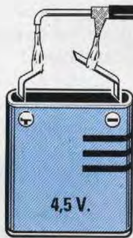
Fig.11 La calza esterna di un cavetto schermato rappresenta per il segnale BF il "secondo" filo. Per capire ciò possiamo paragonare la "sorgente" ad una pila e la lampadina al transistor presente nel preamplificatore. Nel filo interno del cavetto scorrerà la tensione positiva e nel cavo esterno la tensione negativa.
