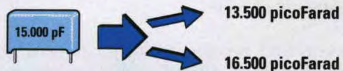
Fig.86 Un condensatore da 15.000 picofarad con una tolleranza del 10% può in pratica presentare un valore compreso tra 13.500 picofarad e 16.500 picofarad.
