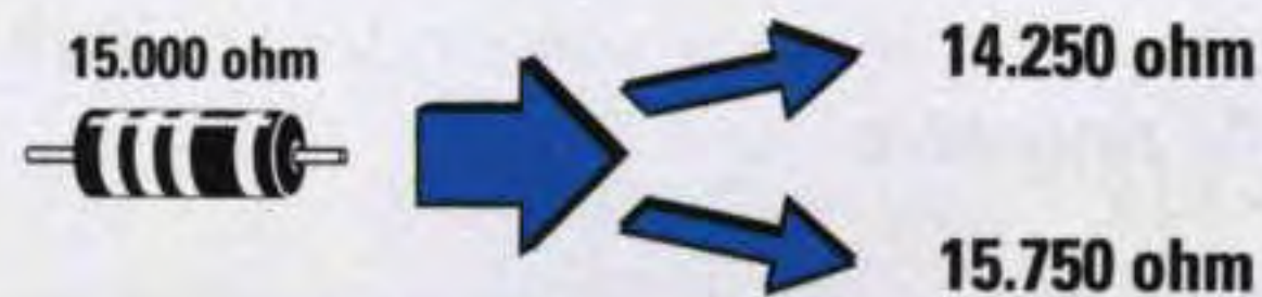
Fig.85 Tutti i componenti hanno una loro tolleranza, quindi non meravigliatevi se una resistenza da 15.000 ohm ha un valore compreso tra 14.250 e 15.750 ohm.
