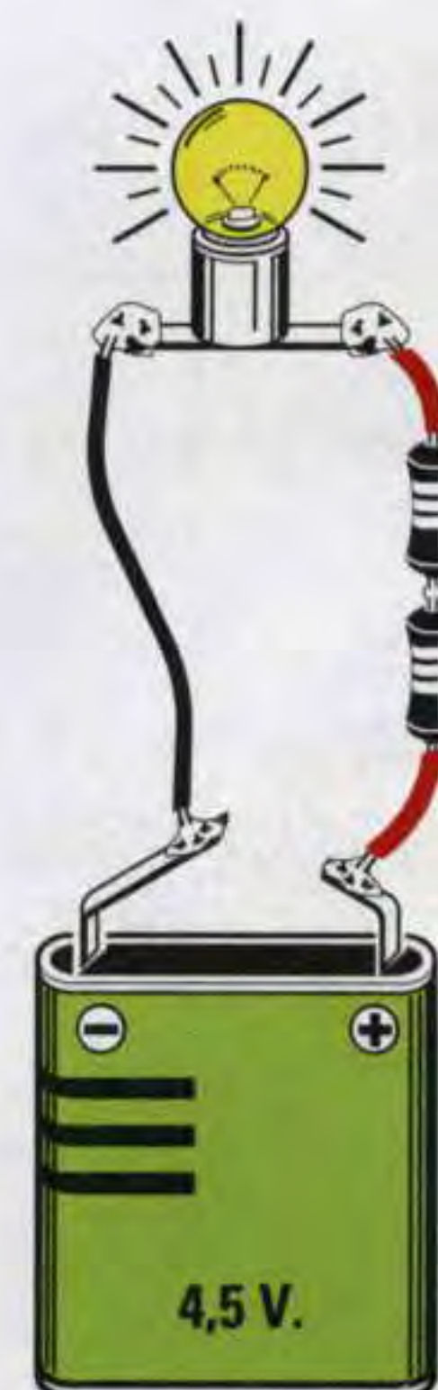
Fig.63 Se applichiamo in serie due resistenze da 10 ohm vedremo ridurre notevolmente la luminosità della lampadina perché avremo dimezzato il flusso degli elettroni.
